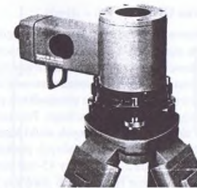
Rys. 1.43. Automatyczny pionownik zenitowy ZL lub nadirowy NL Wilda
