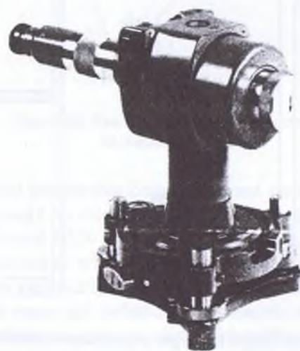
Rys. 1.42. Libelowy pionownik zenitowo-nadirowy ZNL Wilda
